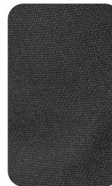
Le Cordura® polyamide, très résistante à l'usure et à l'abrasion. Utilisé en renfort.
