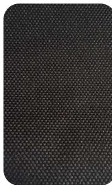
L'Oxford a un aspect de tressage carré obtenu à partir de fils de chaînes et de trames doublés. Utilisé en renfort.
