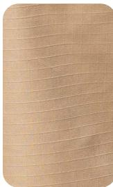
Le Ripstop (issu de l'armure toile) renforcé par une fibre complémentaire lui donnant sa structure en damier et lui permettant d'éviter les déchirures.
