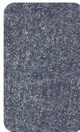
Le denim est un sergé de coton avec la spécificité d'avoir des fils de coloris différents en chaîne (indigo) et en trame (écru). Se délave au fur et à mesure des lavages en raison de son procédé de teinture.
