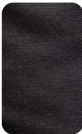
L'armure Toile n'a ni envers, ni endroit : elle forme des carrés sur chaque face. Très résistante à la traction et à l'abrasion. Tissu bloqué et peu déformable.
